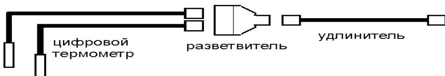
Закрепите датчики температуры и датчик влажности внутри инкубатора, а штекеры датчиков подключите к разветвителю. Один конец удлинителя подключите к регулятору, а другой к разветвителю. Подключите к регулятору блок питания и вставьте его в розетку.
